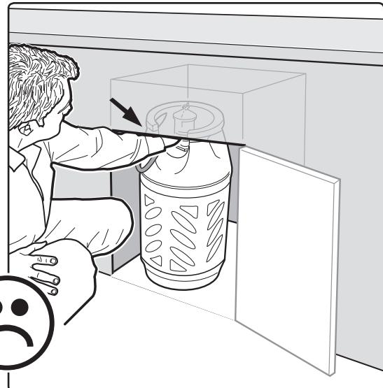
Установите держатель баллона сверху встроенного бака, используя нержавеющие крепежные детали. **КРЕПЕЖНЫЕ ДЕТАЛИ ДЛЯ УСТАНОВКИ НЕ ВКЛЮЧЕНЫ В КОМПЛЕКТ.** ♦
