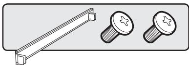
Временно установите панель регулировки переднего колеса, используя всего по одному болту на каждой стороне.
