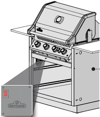
Переведите переключатель в положение "ON", расположенный на панели управления. Панель управления находится слева от внутренней части вашего шкафчика, где была установлена верхняя часть гриля. (См. раздел "Установка панели управления" для дальнейшей информации.)
